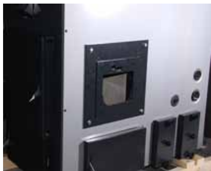
Brännaradaptern fastskruvad på pannan.
