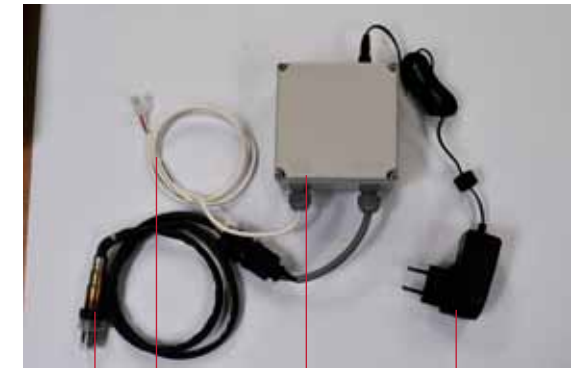
Ohjainyksikkö Lambda-anturi Mittausviestikaapeli kattilan ohjainkortille sis. liittimen. Virtalähde (230Vac/12 Vdc)
