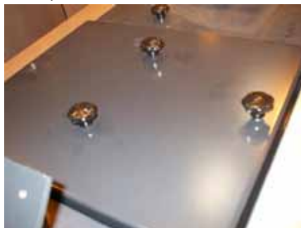
8. Asenna puhdistusluukku paikoilleen ja kiinnitä tähtinupit.
