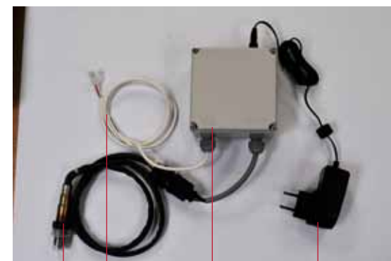
Labels for the lambda probe components: Lambdasonde Messsignalkabel für Kesselsteuerkarte einschl. Anschluss. Stromquelle (230 VAC/12 VDC) Steuereinheit
