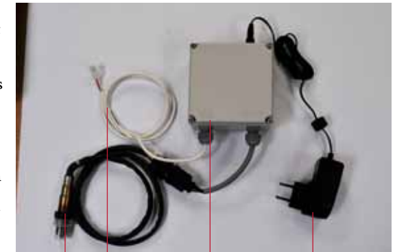
Labels for the lambda probe components: Lambdasonde Messsignalkabel für Kesselsteuerkarte einschl. Anschluss. Steuereinheit Stromquelle (230 V WS/12 V GS)
