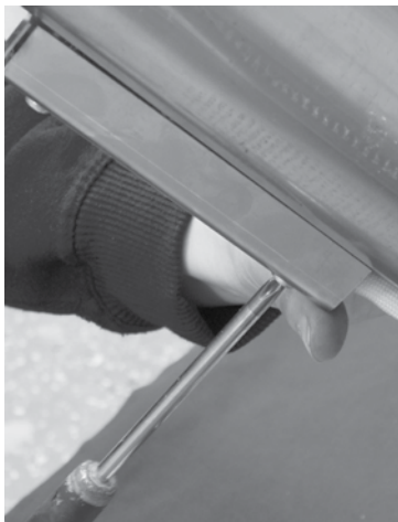
4. Kiinnitä kotelo ja takapalosuoja polttimen syöttöputken mukana tulevilla ruuveilla.
