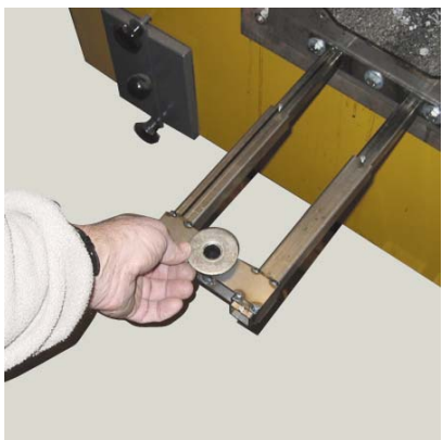
3. Montera distansbrickan på gejdervagnens rör.
