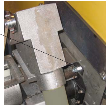
2. Montera medföljande 2 st M8-skrivar (1) och brickor på dockningsplåten.
