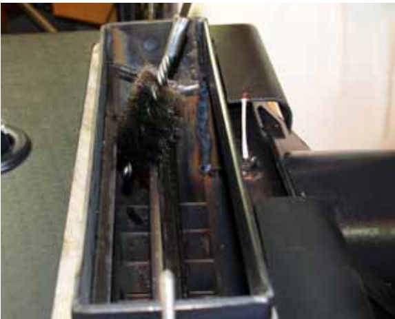
Puhdista huolella kaikki konvektorin ripojen välit.
